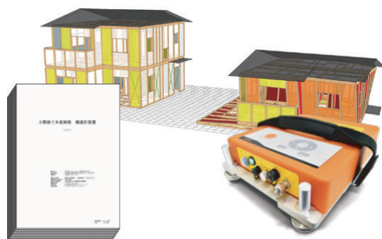
「地震に強い家づくり」のために、微動探査による地盤状態の計測・wallstatによる倒壊シミュレーション・構造計算を行い、最適な構造プランを提案
