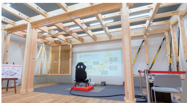
専用スペースに設置された地震ザブトンで、直下型地震や海溝型地震、長周期地震動などさまざまな揺れが体験可能
