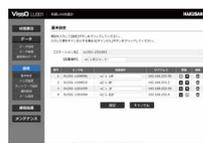
Webブラウザでネットワークを経由してLU301に接続し、各種設定や状態確認、計測した地震波形の確認やデータのダウンロードなどが行えます。
