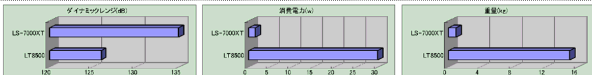
当社テレメータ製品 LT8500 との比較 (100Hz サンプリング 6 チャンネル計測時)
